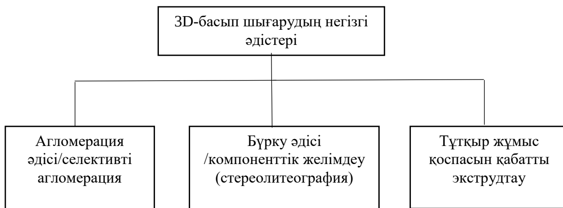
Сурет 1. Құрылыста қолданылатын басып шығарудың негізгі әдістері.
